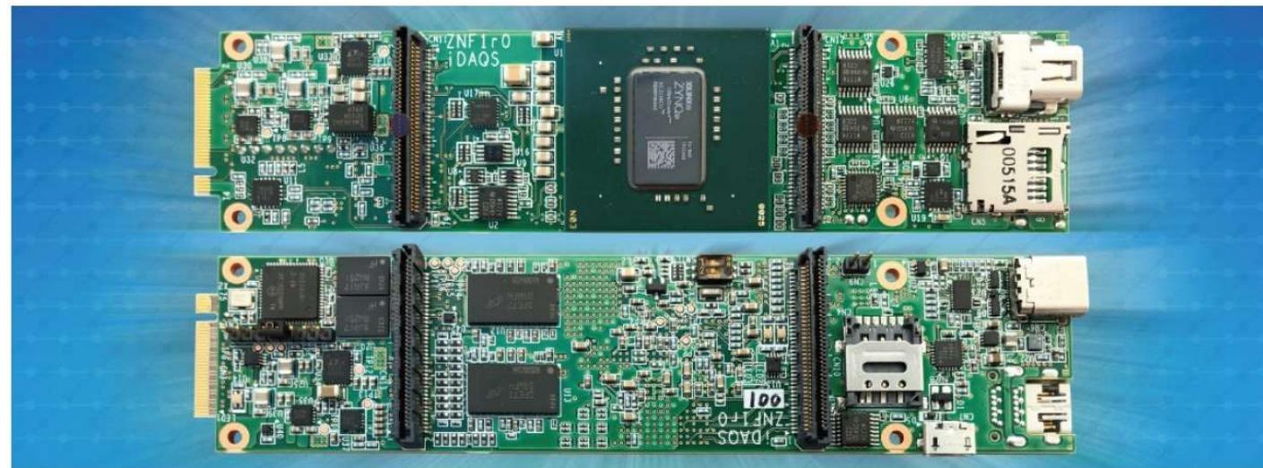
MPSoC搭載、1U高さのサーバーラックに32枚も収納。 XILINX.
